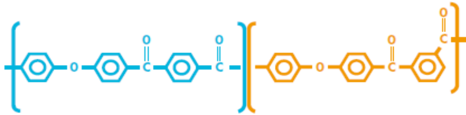
2. ábra Az Arkema PEKK kopolimerjei tereftalát (T) típusú (balra) és izoftalát (I) típusú (jobbra) monomereket is tartalmaznak
