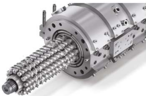
6. ábra A CPM cég RE Ring gyűrűs elrendezésű extruderének nyújtási keverése által szignifikánsan csökkenthető a fajlagos energiaszükséglet
