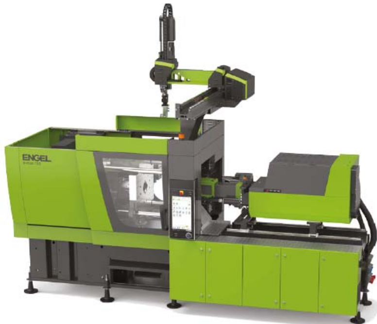
2. ábra Az Engel E-mac 130 , teljesen szervomotoros fröccsgépe
