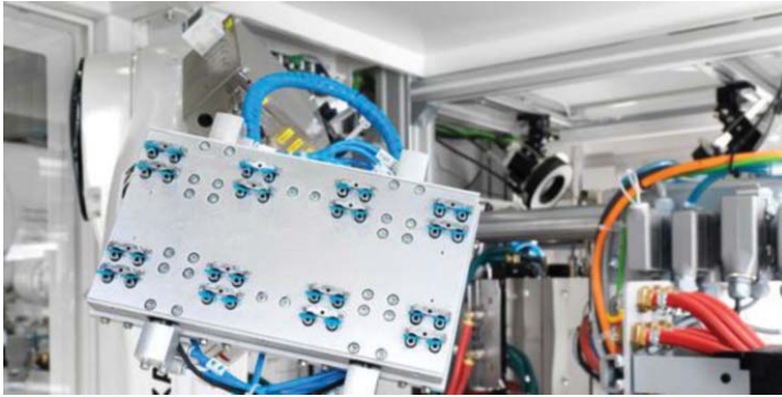
5. ábra. 8-fészkes nyitott szerszám a mikromembránok kiemelése előtt.
