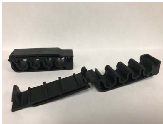
4. ábra 3D nyomtatással készült alkatrészek hulladékából fröccsöntött autóalkatrészek
