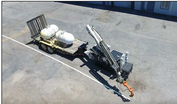
6. ábra. Az MIT egyetem önjáró 3D nyomtató berendezése
