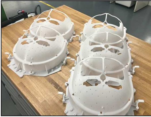
4. ábra A GE Healthcare cég PEI alapanyagból 3D nyomtatással (FDM) készült MRI fejrész antennái
