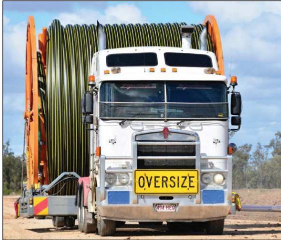
5. ábra A mobil csőgyárban előállított több száz méter hosszú PE-HD cső szállítása a fektetés helyére
