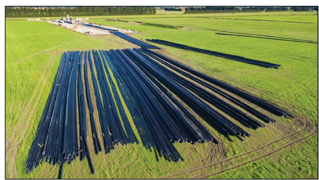
4. ábra A „zöldmezős” gyártásban a csövek hosszát (majdnem) semmi sem korlátozza
