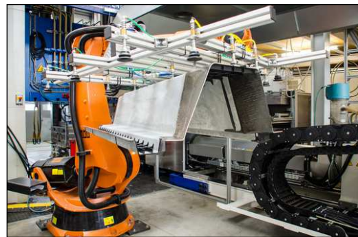
2. ábra. Az ILK intézetben egy robot éppen szereli az erősítő keresztrudakat a hibrid fém/műanyag padló és a központi alagút közé
