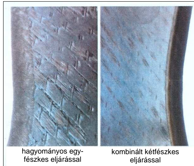
8. ábra Hagyományos egyszerszámos és kombinált (kétfészkes) szerszámmal gyártott fékpedál hátsó felülete
