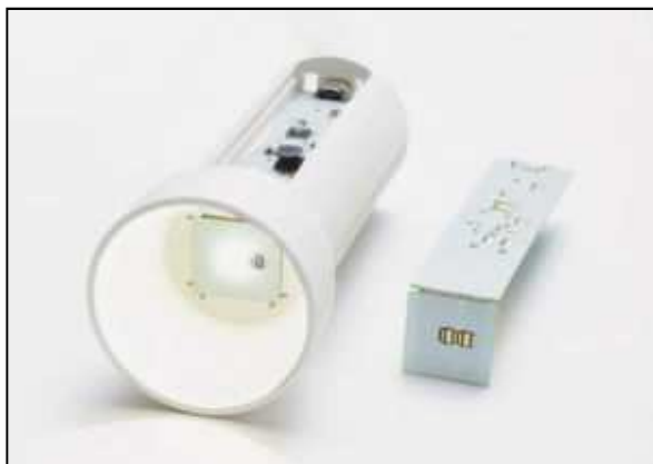
3. ábra Az elektromos alkatrészeket hordozó jobboldali panelre jó hővezető képességű bór-nitriddel töltött PET-ből egy lépésben ráfröccsöntött burkolatú LED zseblámpa
