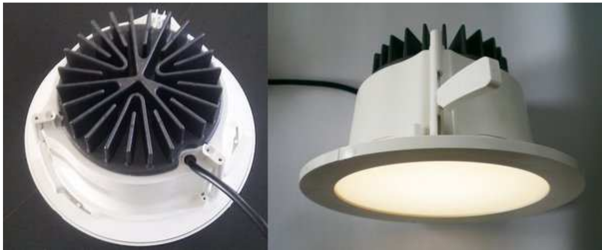
4. ábra Therma-Tech kompaundból fröccsöntött LED lámpa hűtőegységének teljesítménye jobb, mint a korábbi alumínium változaté
