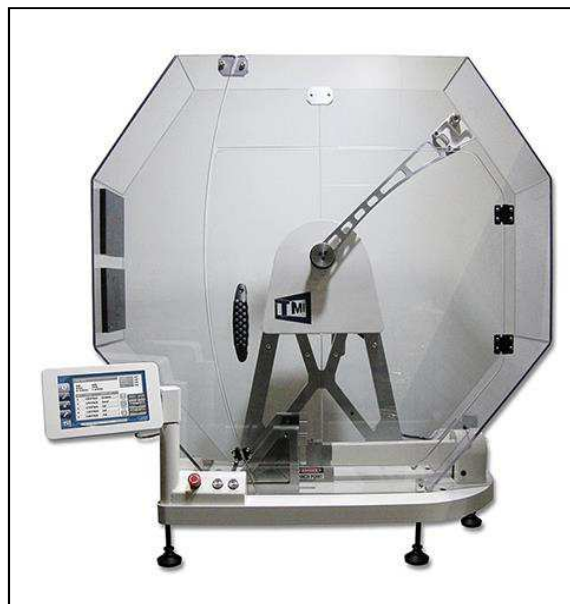
5. ábra Észak-Amerikában használt szabványos ütészállósági vizsgálatra alkalmas készülék, gyártó: Testing Machine Inc.
