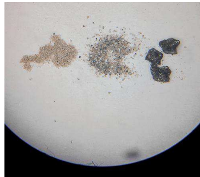
2. ábra A szóráshoz leggyakrabban alkalmazott 320-as (balra), 180-as (középen) és 24-es (jobbra) szemcseméretű alumínium-oxid mikroszkóp alatti képe
