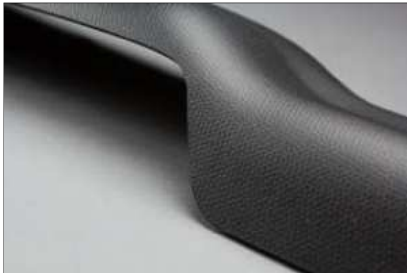
4. ábra A BMW i3 modell Pulse GX50 (PC+ABS) keverékből készített, lakkozás nélküli, strukturált felületű ajtóküszöbje
