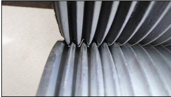
3. ábra Poli-V-profillal ellátott tárcsa és szalag érintkezése
