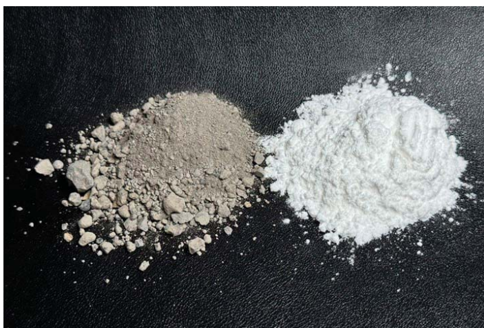
1. ábra. Az acél kohósalak átalakítása endurocal® töltőanyagá (forrás: ptonline).
