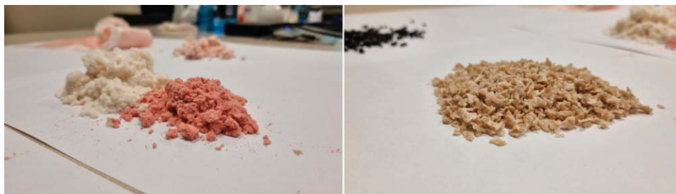
1. ábra. A feldarabolt hulladék színe a kémiai elválasztás előtt és utána (balra), valamint a kompaktált, tisztított szálak (jobbra).
