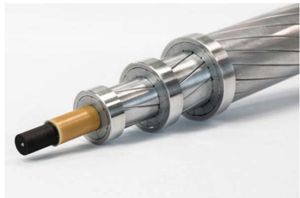
2. ábra. A HVCRC ® kábel szerkezete, közepén a szénszál tartalmú, pultrudált tartókábellel.
