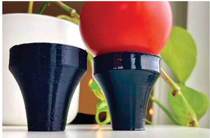
1. ábra. Egy hagyományos 3D nyomtatott (bal oldalt) és egy Hyperflow 4D technológiával nyomtatott (jobb oldalt) tárgy képe. Látható, hogy a jobb oldali tárgynak nemcsak a felülete simább, hanem kisebb a mérete is (nincsenek belső üregek).
