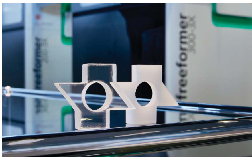
1. ábra. A munkadarabok átlátszósága attól függ, mennyire szorosan helyezik el a cseppeket a gyártás során.
