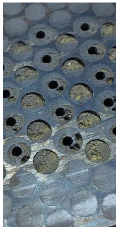
1. ábra. A savtámadás komoly károkat okozott a vágófelületen (Fotó: Maag).
