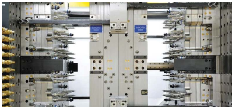
5. ábra. A Husky Technologies Ichor fröccsöntő rendszere vérminta gyűjtő csövek gyártására.
