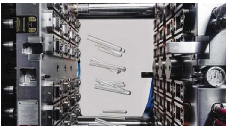
3. ábra. Az MHT Mold & Hot Runner Technology és a Kebo által fejlesztett szerszám vérminta gyűjtő csövek előállítására.
