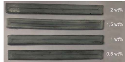
6. ábra. A különböző mennyiségű szórt rövid szénszálal tartalmazó, PLA-ból készült nyomtatott minták képe.
