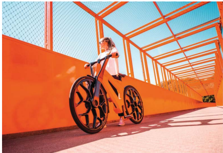
1. ábra. Az mtrl által tervezett igus:bike újrahasznosított műanyagból, köztük például használt halászhálóból készül, nem rozsdásodik, kenést nem igényel, és jóformán karbantartásra sincs szüksége.
