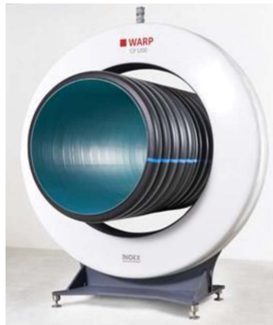
5. ábra. A WARP-C radar falvastagság mérő a mért csővel (Fotó: Inoex).
