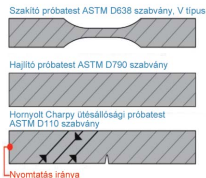
5. ábra. A próbatestek nyomtatásának körülményei.
