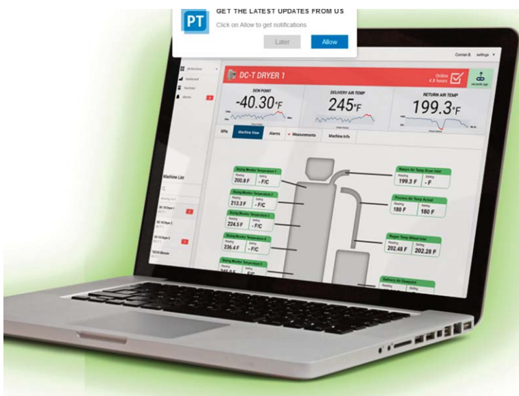
1. ábra. Egy szárítóegység működését bemutató monitor program a számítógép képernyőjén (Forrás: Conair).
