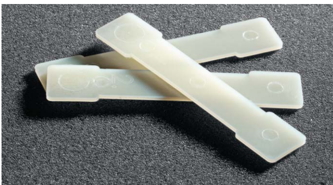
7. ábra. A pálcaalakú próbatestek löketsúlya: 4 g, folyási út hossza: 90 mm, falvastagsága: 2 mm.
