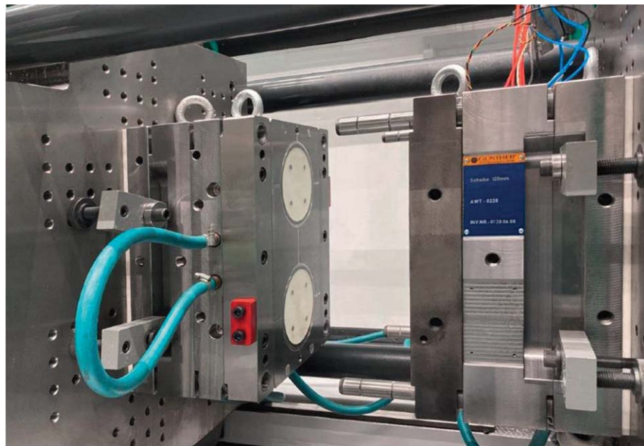
4. ábra. A Günther cég kétfészkes kísérleti szerszámába cserélhető betétek építhetők be a különböző próbatestek számára, a fűvókák oldalán pedig választható módon csúcsos nyitott fűvókákkal vagy túszelepes fűvókákkal lehet felszerelni.
