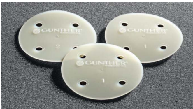
5. ábra. A tárcsaalakú próbatestek löketsúlya: 3 g, átmérője: 60 mm, falvastagsága 1 mm.
