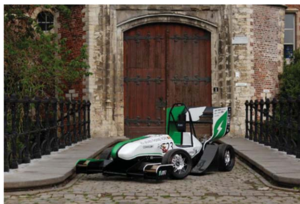
2. ábra. Formula Electric Belgium Team 220 kg-os versenyautójának első szárnya és teljes fenéklemeze EconCore rPET méhsejt maggal készült.
