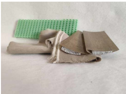
1. ábra. Formula Electric Belgium Team versenyautó szívós első szárnya 50 gramm tömegű sajtolt természetes szállal társított rPET méhsejt maggal készült.
