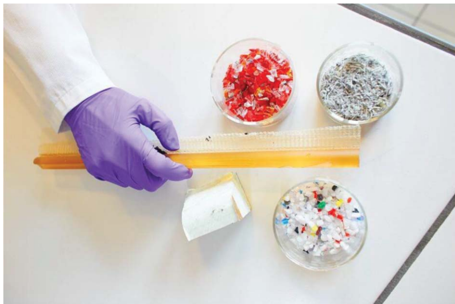
2. ábra. Az Elium ® gyanta kémiai újrafeldolgozásával nyert gyanták és üvegszálak.
