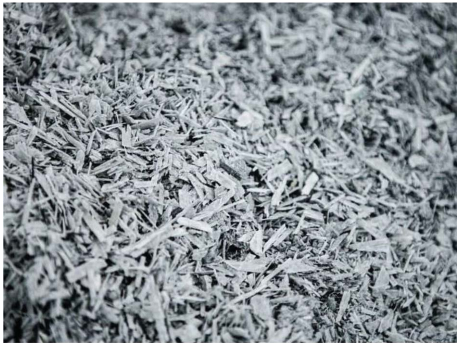
1. ábra. Egy Elium® gyantával készült szélturbina lapát feldarabolás után (Forrás: Arkema).
