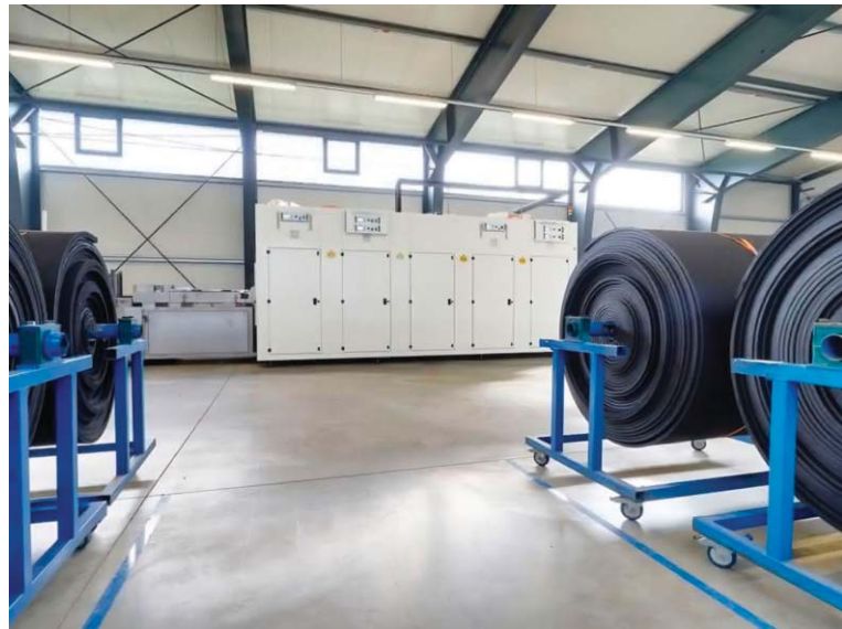
1. ábra. A mikrohullámú szárítóegység 90%-os hatásfokkal dolgozik és biztosítja az impregnált szalagok megbízható száradását. (A kép forrása: Weiss Technik.)
