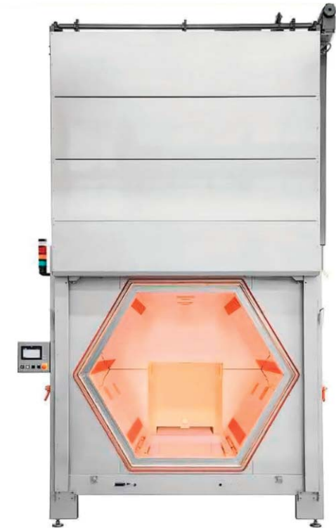
2. ábra. A hatszögű kemencegeometria biztosítja a hatékony és homogén szárítást. (A kép forrása: Weiss Technik)
