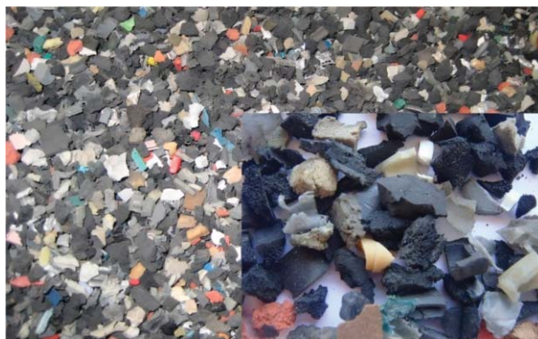
1. ábra. Elkülönített elasztomer frakció a Hamos RSS-ből való leválasztás után
