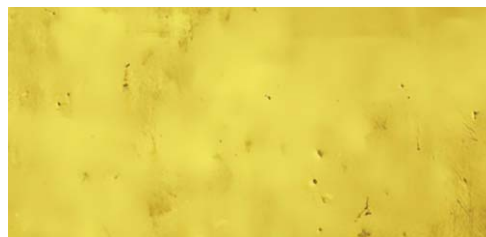
3. ábra. Reciklált granulátumból fröccsöntött műanyag lemezen megjelenő fekete szemcsék
