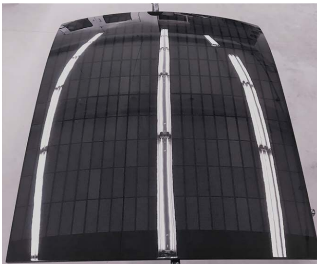
2. ábra. Integrált napelemes fóliát tartalmazó gépkocsi tetőpanel (Audi).
