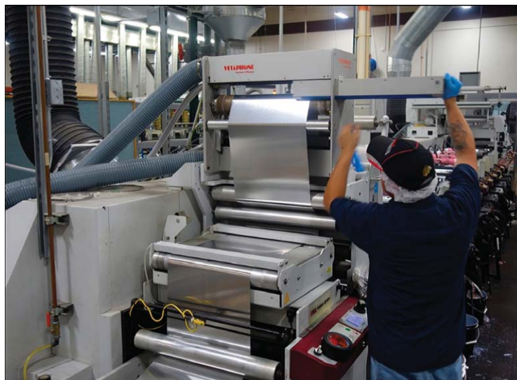
1. ábra. A Vetaphone koronás kezelőegysége az LMI Packaging cég flexográfás nyomtatógépén (Forrás: Vetaphone).
