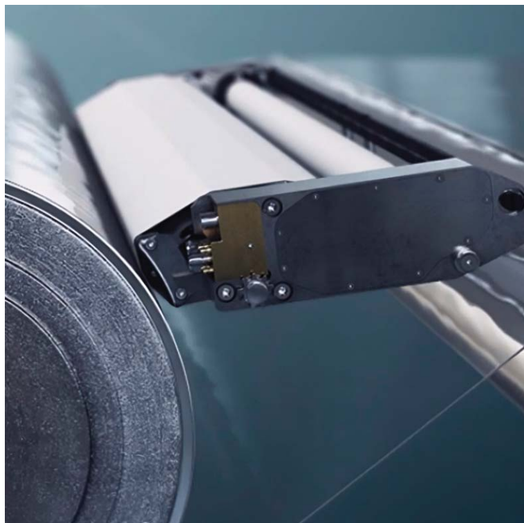
3. ábra. A Baldwin Ahlbrandt koronakezelő egysége. (Forrás: Baldwin).
