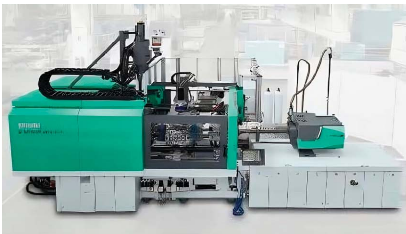
10. ábra. Az Arburg háromkomponensű Allrounder Cube 1800 funkcionális alkatrészt fröccsöntött PP-ből, TPE-ből és POM-ből (Fobo 48 fészkes szerszám).
