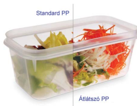
4. ábra. Millad NX 8000 hatása a PP átlátszóságára.
