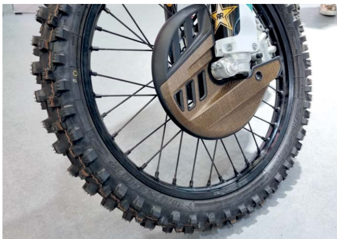
2. ábra. A féktárcsavédő gyártási eljárása lehetővé teszi a hőre keményedő és az Akro-Plastik hőre lágyuló bioalapú poliamidjának tökéletes összeillesztését.
