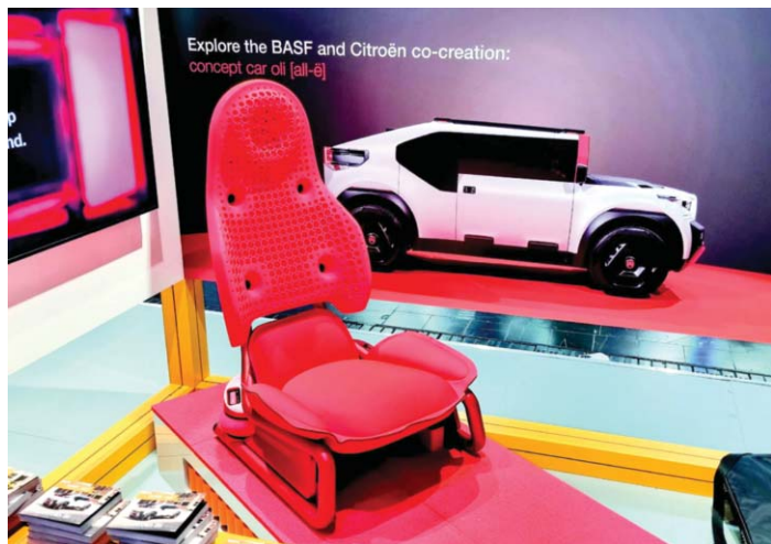
5. ábra. A Citroën és a BASF járműtanulmányában bemutatott fenntarthatóbb és megfizethetőbb elektromos autóban az ülések teljes egészében egy monoanyagból készülnek a könnyebb újrahasznosíthatóság érdekében.
