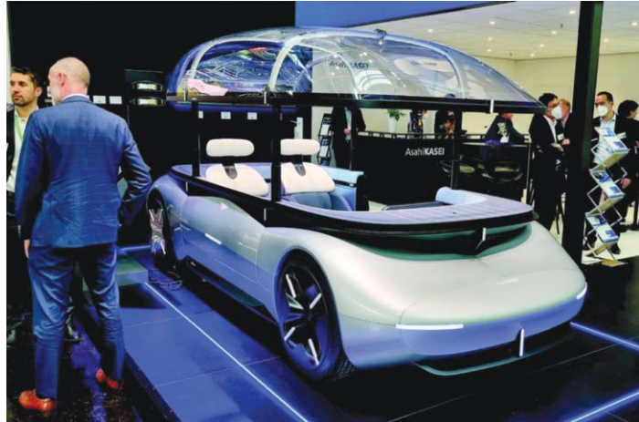
4. ábra. Az Asahi Kasei koncepcióautójának kupolatetője a szélvédő üvegekre előírt követelményeket is teljesítő polikarbonátból készült.
