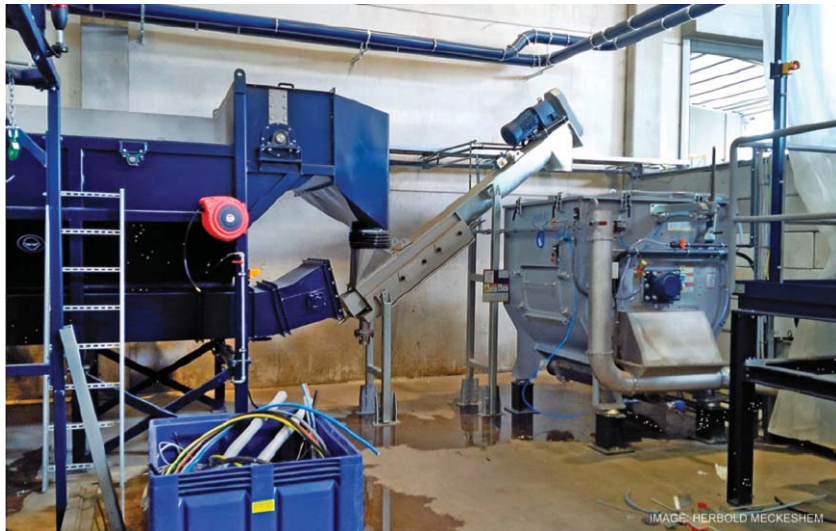
3. ábra. A Herbold Meckesheim technológiájában a PP darálék felülúszóként kerül tovább a mechanikai szárítóba.
