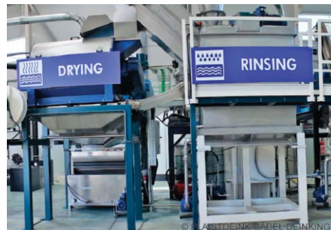
7. ábra. A PLASTDEINK projekt keretében kifejlesztett berendezés, amellyel nyomtatott műanyag felületekről a tinta eltávolítható
