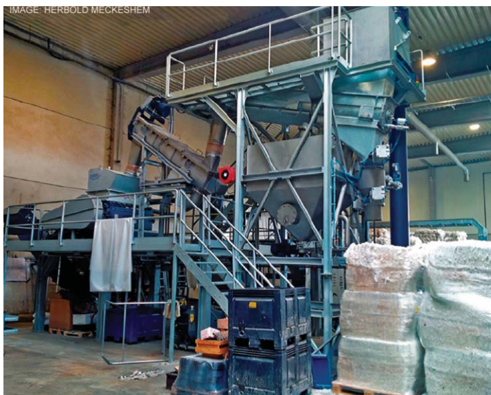
2. ábra. A durva anyagot leválasztó egység, a frikciós mosó- és a nedves őrlőberendezés a Herbold Meckesheim technológiájában.
