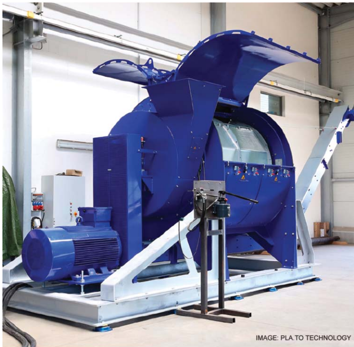
5. ábra. A Pla.to Technologies zárt ciklusú HDPE és PP újrahasznosító rendszere, amely képes a papírcímke maradványainak eltávolítására és nem termel szennyvizet.
