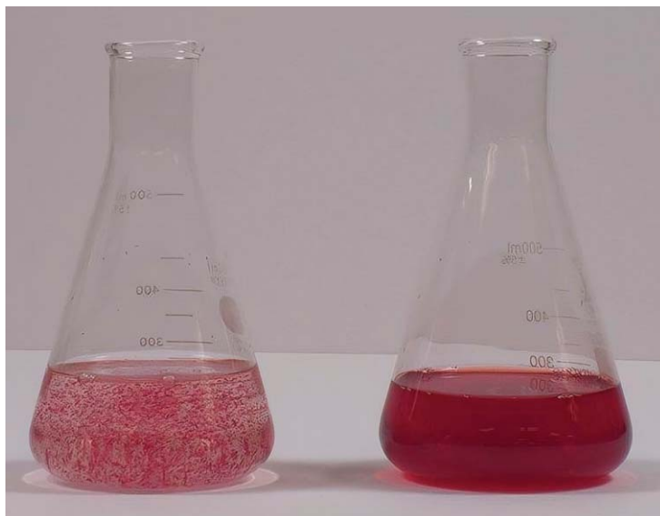
8. ábra. A SolvaWash festék (balról) nagyobb szemcsék formájában távolítható el a vizes mosófolyadékból, mint a hagyományos festék (jobbról), ezért könnyebben szűrhető.
