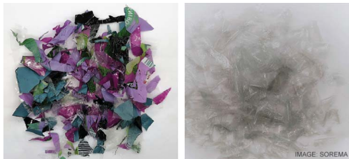
1. ábra. Rugalmas falú nyomtatott kis sűrűségű polietilén hulladék a Soerma cég által fejlesztett festékeltávolítási eljárás alkalmazása előtt (bal oldalon) és után (jobb oldalon).
