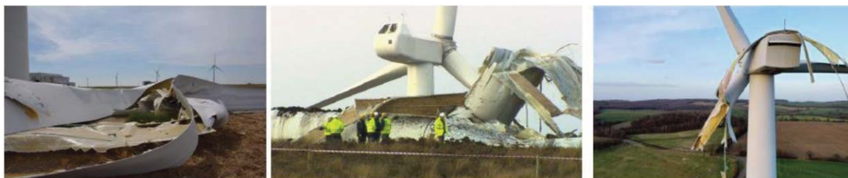
3. ábra: Szélturbina lapátok tönkremenetele az erózió következtében.
