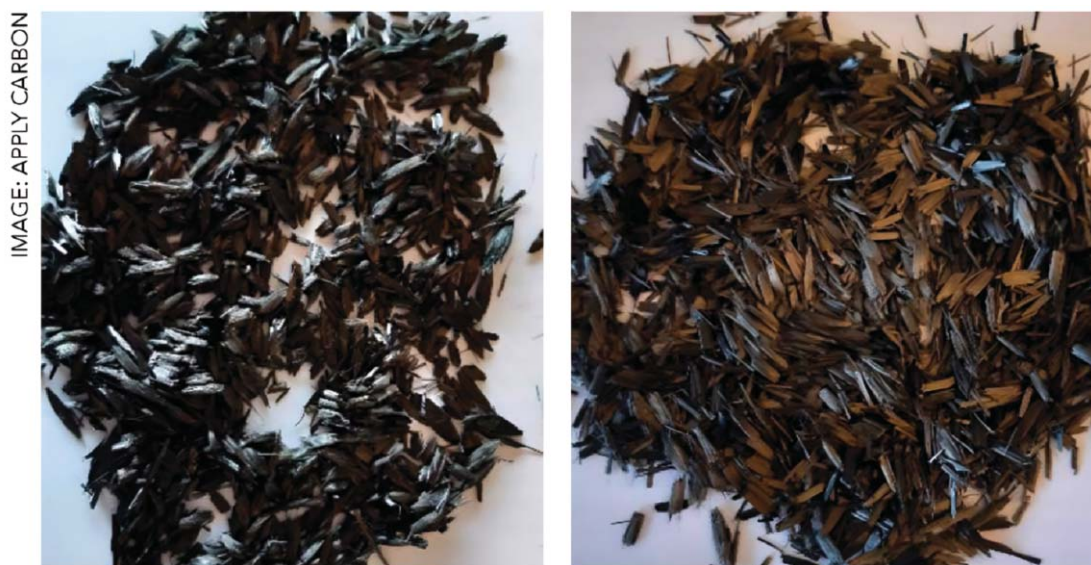
Az Apply Carbon új Carbiso P újrahasznosított szénszál pelletjei 3 mm-es (balra) és 6 mm-es (jobbra) szálhosszúsággal a PA, PP, PBT, PPO vagy POM kompatibilitás érdekében felületkezelve.
