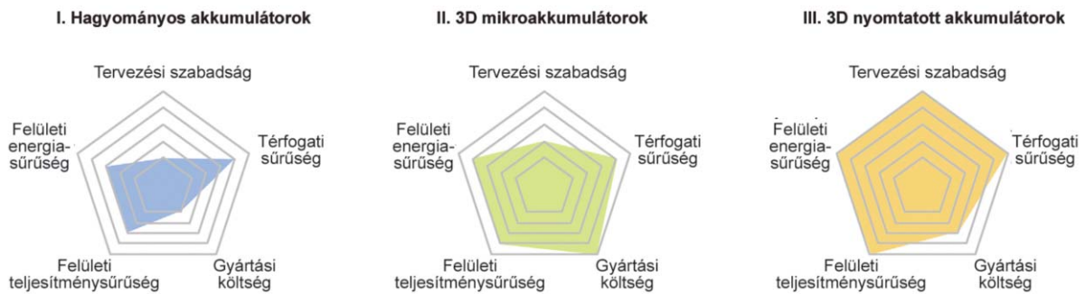
1. ábra. A hagyományos Li-akkumulátorok, a 3D-mikroakkumulátorok és a 3D nyomtatással előállított akkumulátorok gyártástechnológiáinak vázlatos összehasonlítása. (Forrás: Lyu és társai, 2021.)
