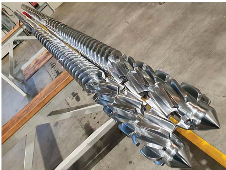
2. ábra. Egy optimalizált, párhuzamos elrendezésű ikercsigás rendszer. (Forrás: Willaims, 2021.)
