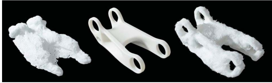
1. ábra. Középen: fröccsöntött szálerősített tárgy. Baloldalt: a visszamaradó szerkezet a műanyag eltávolítása után rövid szállal erősített műanyagban. Jobboldalt: a visszamaradó szerkezet a műanyag eltávolítása után hosszú szállal erősített műanyagban.
