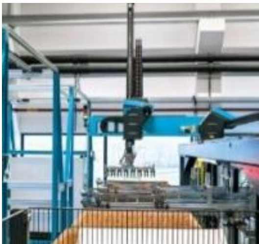
5. ábra A Viper 40 robot kiemeli a kupakokat a szerszámból ...
