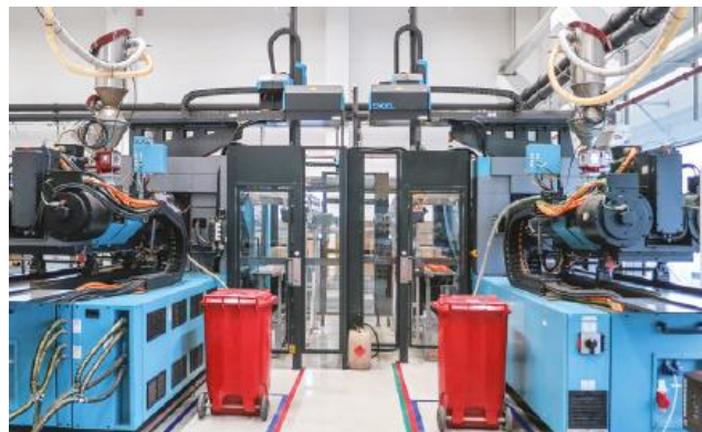
4. ábra A Steinbach cégnél felállított két Engels e-fröccsgép, amelyeket a gépek mögött, a mennyezet alatti vízszintes állványon mozgó Viper 40 típusú robot szolgál ki
