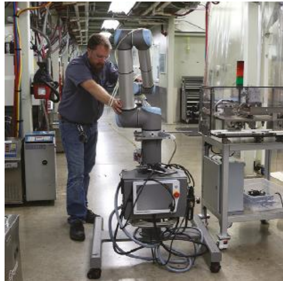
2. ábra Az URS egyik kerekeken mozgatható mobil robotja
