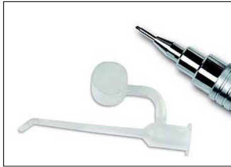
2. ábra Szemészetben alkalmazott sebészeti eszköz, amelynek PP-ből készített cső alakú csúcsa mindössze 0,1 g, a cső belső átmérője 0,6 mm, falvastagsága 0,17 mm, de a legvégénél 0,1 mm-re vékonyodik
