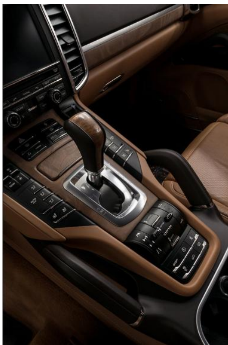
1. ábra A Kraton fröccsöntött IMSS burkolatával fedett középvezeték
