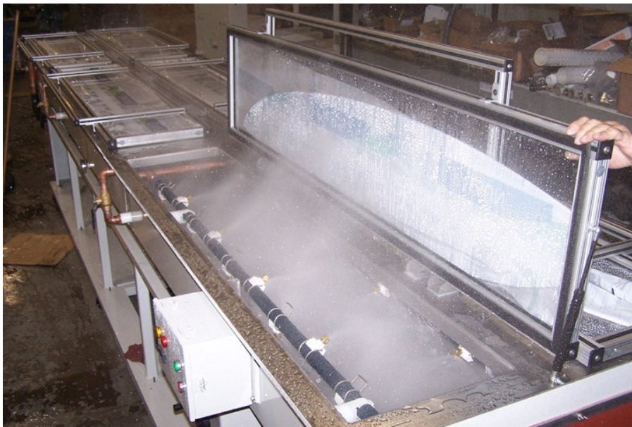
3. ábra A két permetezőtartály nagy intenzitású párologtató hűtést biztosít a nagyobb profilok extrudálásakor
