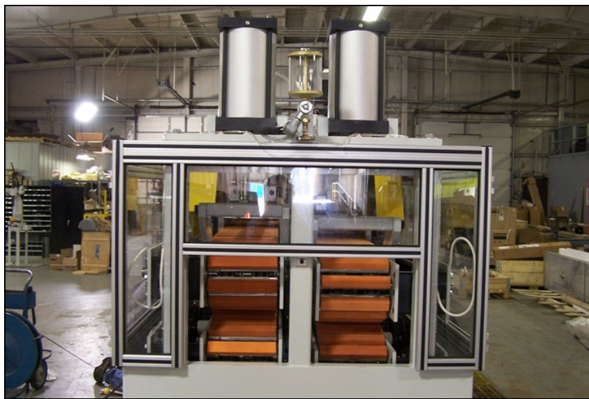
2. ábra Kettős vezetésű lehúzó biztosítja az egyes profilok megfelelő minőségét
