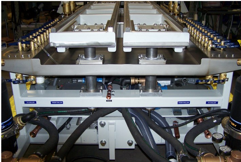
1. ábra A kalibrációs asztalok olyan profilspecifikus szerszámokat tartalmaznak, amelyek képesek vákuumot létrehozni, ez segít stabilizálni az extruderből kilépő profilok alakját. A vákuumszivattyúk az asztal alján találhatók
