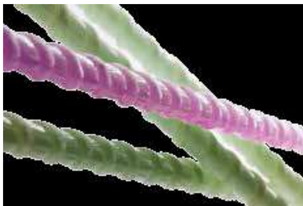
1. ábra A Krauss Maffei második iPul berendezésén gyártott üvegszálás Rebar rudak betonszerkezetek erősítésére
