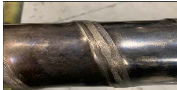
3. ábra Dörzsölési kopás pl. ásványi töltőanyagok vagy üvegszál erősítés hatására
