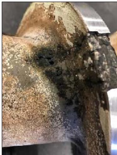
4. ábra Korrozív kopás, pl. PVC, fluor-polimerek, vagy égésgátló adalékok hatására
