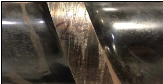
2. ábra Tapadási kopás a csiga és a henger falának összehegedését követő szétszakadása következtében
