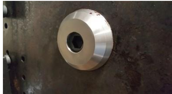
2. ábra A tájolótüske a záróegység állórészének furatában
