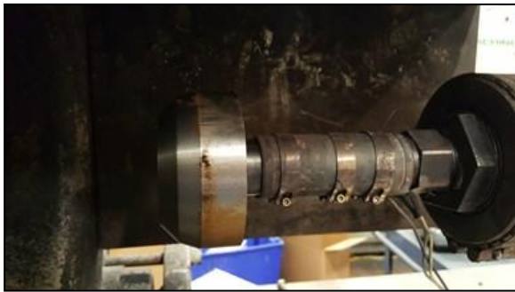
1. ábra A tájolótüske a fűvókatestre csavart állapotban
