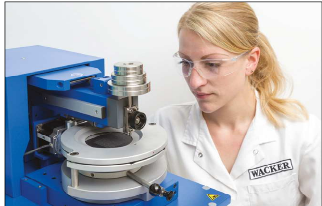
8. ábra A Wacker laboratóriumában az Erichsen cég berendezésével korongon mérik a karcállóságot
