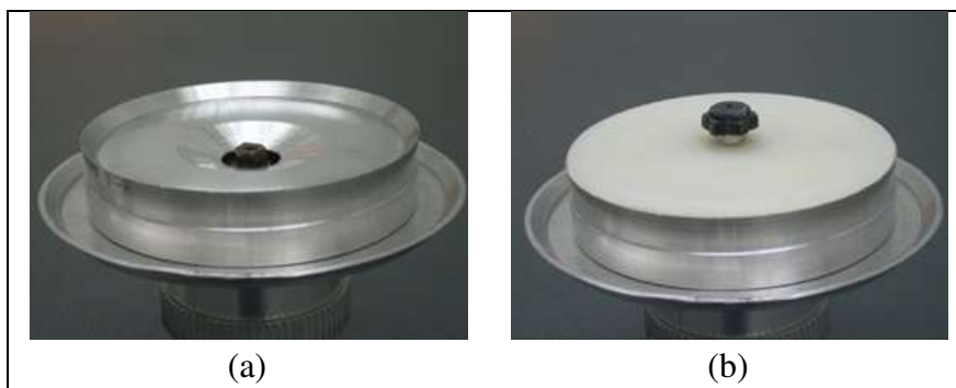
2. ábra Elektrosztatikus szálképző berendezés peremes feje fedél nélkül (a) és fedéllel (b)
