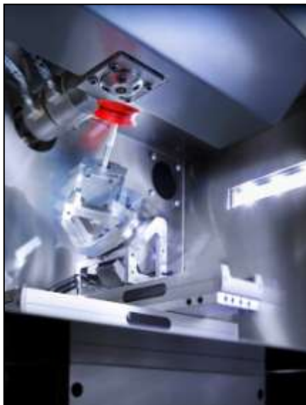
4. ábra Az AKF berendezés polimer ömlékcseppekből építi fel rétegről rétegre a terméket. A fúvóka fix, a tárgyasztal mozog
