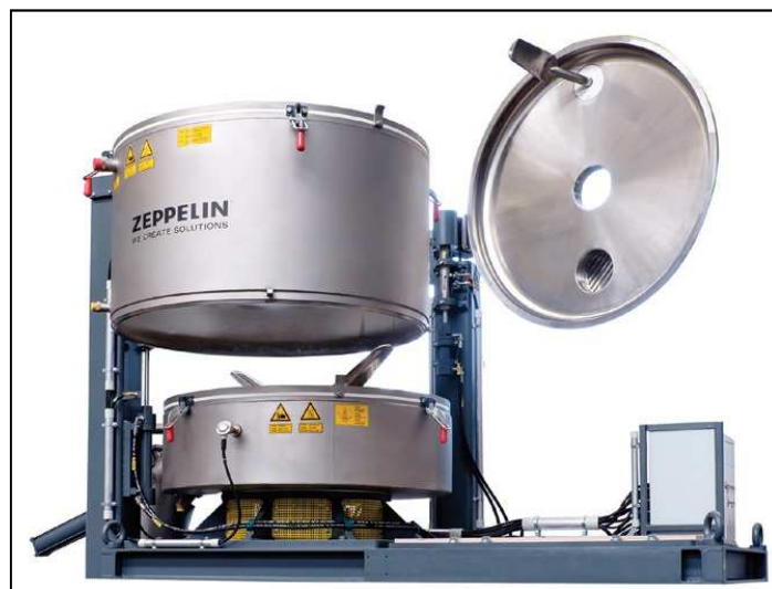
2. ábra Hidraulikus emelőegységekkel ellátott keverőedény a Zeppelin Systems cégtől
