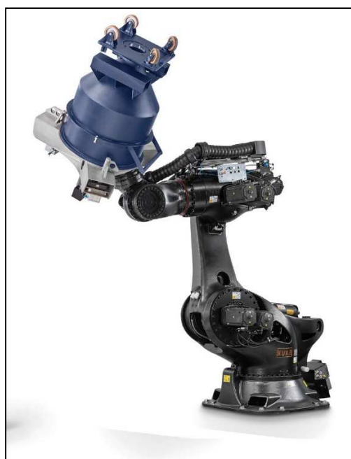
1. ábra A C tec PRO : teljesen automatizált tartályos keverő az MTI Mischtechnik cégtől
